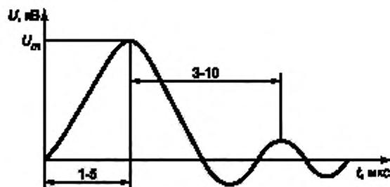
Рисунок Б.3 — Форма импульсов, характерная для точек присоединения  $f, g, l$  на рисунке Б.1.)
