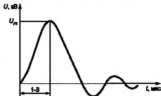
Рисунок Б.2 — Форма импульсов, характерная для точек присоединения а, с, д, е на рисунке Б.1.
