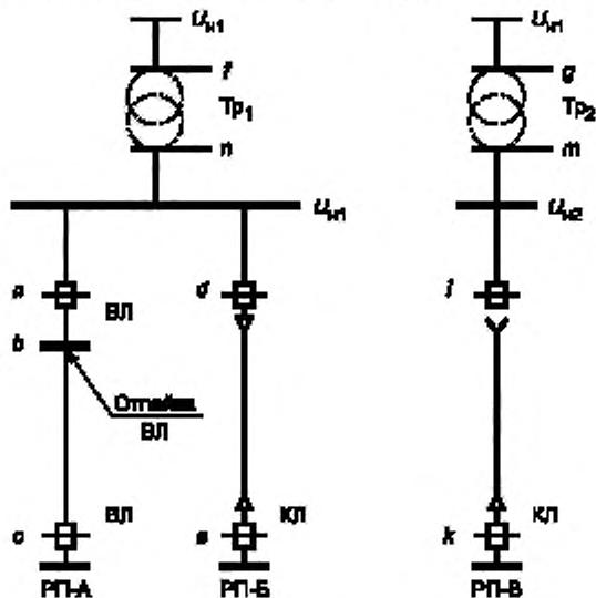
ВЛ — воздушная линия; КЛ — кабельная линия; РП-А, РП-Б, РП-В — распределительные подстанции; Тр<sub>1</sub>, Тр<sub>2</sub> — силовые трансформаторы;  $U_{m1}$ ,  $U_{m2}$  — напряжения на первичной и вторичной обмотках силового трансформатора; а, б, с, д, е, ф, г, к, л, м, п — возможные точки присоединения к электрической сети
