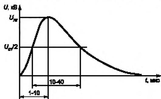
Рисунок Б.4 — Форма импульсов, характерная для точек присоединения  $b, f, k$  на рисунке Б.1.
